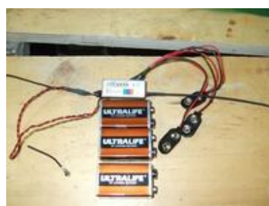
L'ensemble démonté. Les piles étaient déchargées.
