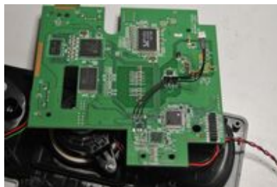
Le plus petit circuit imprimé du téléphone, avec un câblage ajouté pour permettre l'enregistrement de l'audio par le dispositif de surveillance sur l'autre circuit imprimé.
