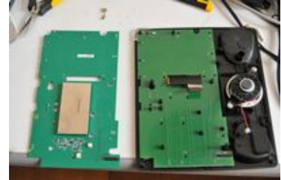
À gauche : version modifiée du plus grand circuit imprimé du téléphone (avec dispositif de surveillance) sans la batterie. À droite : version non modifiée.
